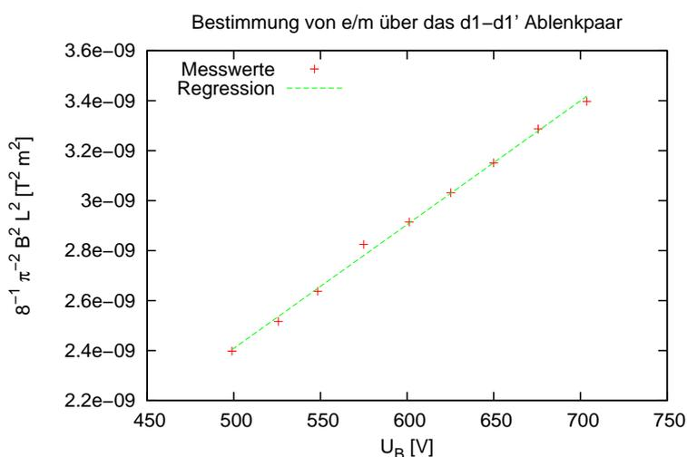
Der Y-Achsenabschnitt ist erwartungsgemäß (innerhalb der Fehlergrenzen) bei Null. Für die spezifische Ladung erhalten wir:
