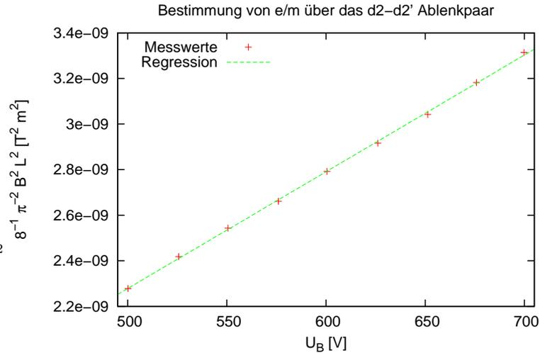
Der Y-Achsenabschnitt ist diesmal nicht erwartungsgemäß innerhalb der statistischen Fehlergrenzen bei Null. Da hier aber die systematischen Fehler noch nicht berücksichtigt sind, ist dies auch nicht allzu gravierend. Für die spezifische Ladung erhalten wir:
