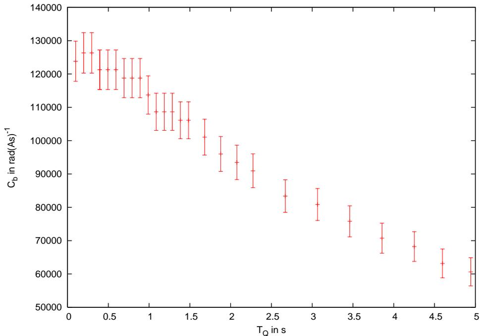
Es wäre zu erwarten, dass für kurze Entladezeiten eine relativ konstante Stromempfindlichkeit vorliegt, der Graph also ein Plateau bildet. Um zu zeigen, dass unsere Messwerte diese Forderung innerhalb der Messgenauigkeit erfüllen, haben wir zusätzlich die Fehlerbalken eingezeichnet<sup>11</sup>. Dadurch ist zu erkennen, dass die Stromempfindlichkeit bis ca  $T_Q = 0,8\text{s}$  nur einen geringen Abfall aufweist. Danach fallen die Werte deutlich schneller.
