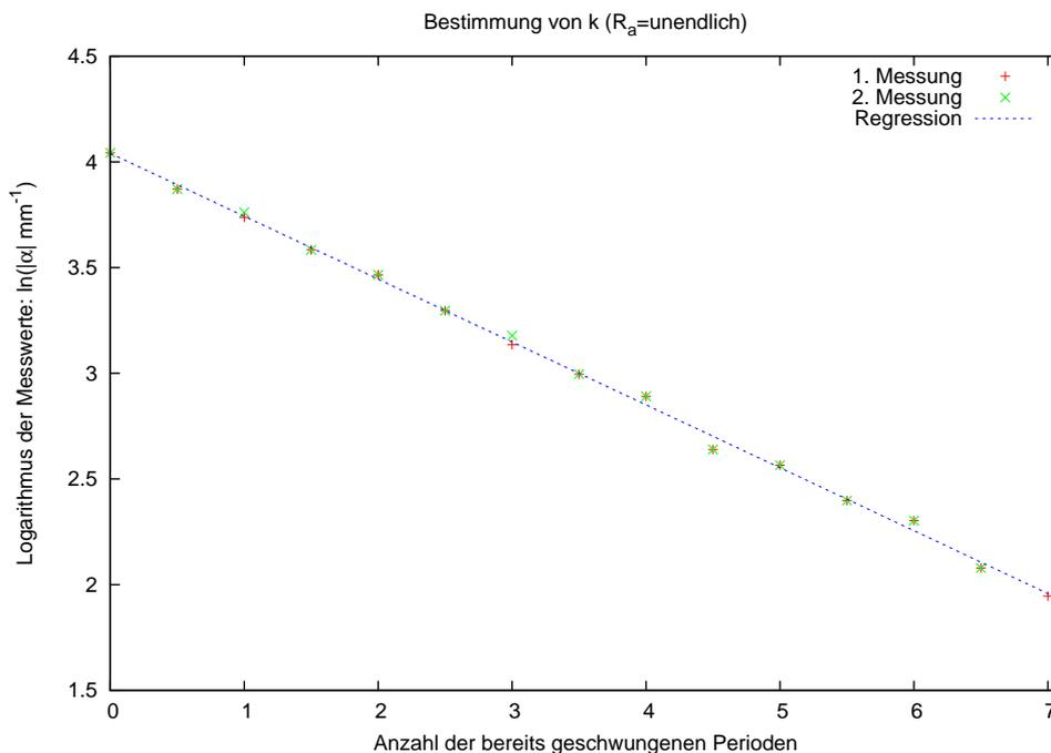
Die Werte  $A, B, \sigma_{A,stat}$  und  $\sigma_{B,stat}$  entstammen der linearen Regression und daraus lässt sich nach der obigen Formel  $k$  berechnen.  $\sigma_{k,stat}$  erhält man durch Benutzung der Gaußschen Fehlerfortpflanzung<sup>4</sup>:
